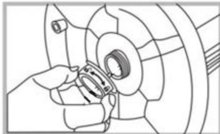
**Schritt 3:** Ziehen Sie die Befestigungsschraube (im Uhrzeigersinn) fest und lassen Sie das Netzkabel durch den Kabelkanal am Rand der Basis führen, um das Produkt flacher und stabiler zu machen. Damit haben Sie die Montage des Turmventilators abgeschlossen. Sichern Sie die Basis mit den 2 mitgelieferten Schrauben.
